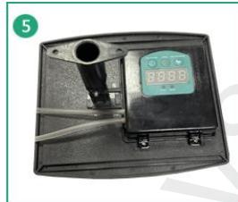
5. Spojite dovod vode na IN, a izlaz na OUT.
