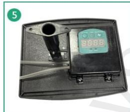
5. Priklučite dovod vode na IN in odvod na OUT.
