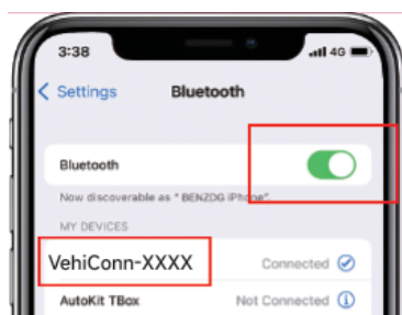
Asocierea adaptorului în setările Bluetooth ale telefonului
