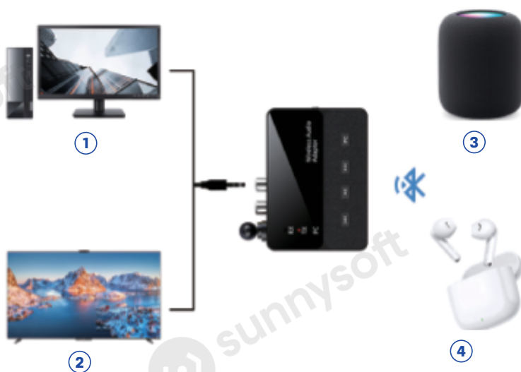
Csatlakoztatás adó üzemmódban (TX)
