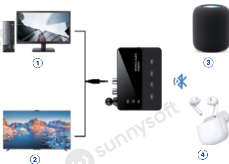
Priključitev v načinu oddajanja (TX)
