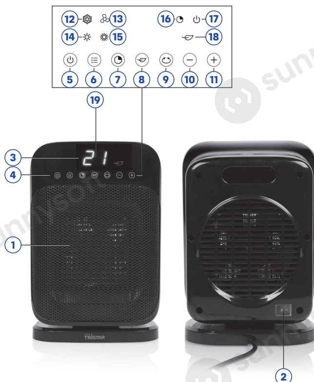
A hőszugárzó előlről és hátulról, felül a kijelzős kezelőpanel részlete
