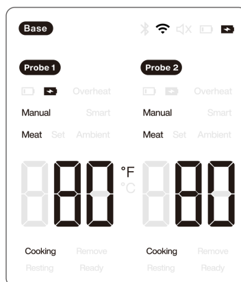
Sonda se správně nenabíjí: ikona nabíjení bliká a bzučák neustále zní. Viz Řešení potíží
