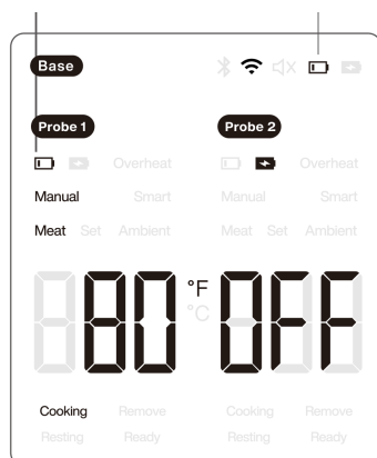
Upozornenie na slabú batériu sondy & základne (slabá batéria sondy 1, slabá batéria základne)
