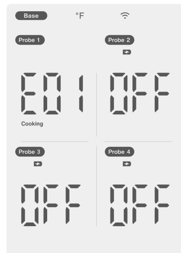
Fühlerstörung, Fehlercode EXX angezeigt
