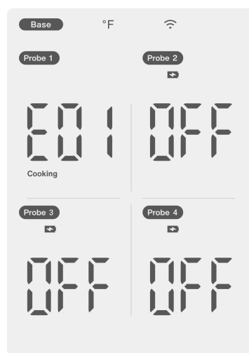
Неизправност на сондата, докладван код за грешка EXX
