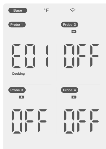
Okvara sonde, sporočena koda napake E01
